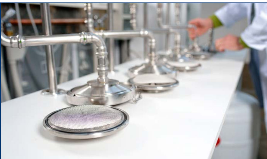
Abb. 1: Das bei den verschiedenen Waschversuchen aufgefangene Abwasser wurde von den Forschenden der Hochschule Niederrhein durch diese Filterkaskade filtriert. Das Filtrat wurde gewogen und anschließend weiter analysiert. Foto: Carlos Albuquerque
